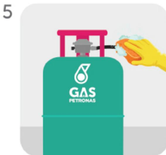
Gunakan ujian air sabun untuk mengesan kebocoran gas. Jika terdapat buih atau bau aneh, tanggalkan alat-atur dan alihkan silinder ke ruang terbuka. Padamkan semua punca api.
